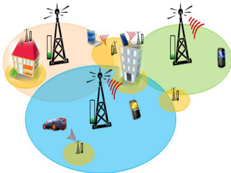
Сотовая связь осуществляется посредством модулированных ЭМИ с несущими частотами 450, 900 и 1800 МГц. Базовые станции поддерживают радиосвязь с абонентами в пределах зоны, радиусом 0,5-10 км, называемой «сотой»
